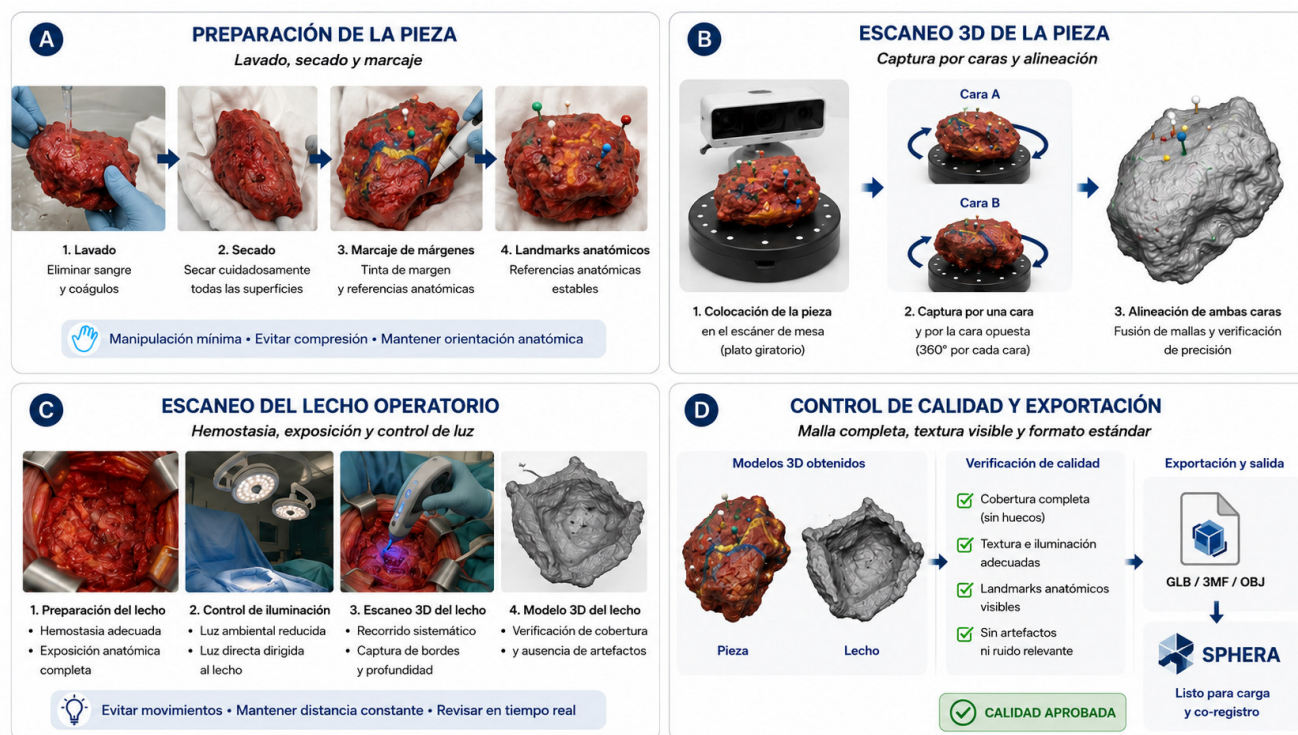
Figura 3. Representación conceptual del procedimiento de preparación, escaneo y control de calidad. Las expresiones de aprobación que aparecen en la ilustración significan control operativo de entrada, no validación de precisión clínica.
